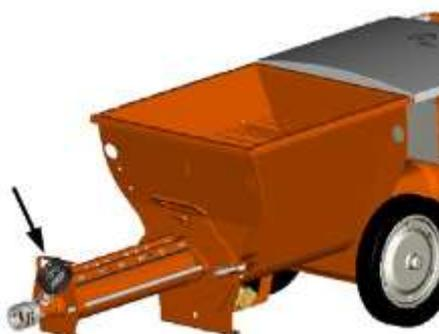
Рис. 23: Манометр давления раствора
