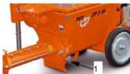
Рис. 36: Открыть очистную крышку
