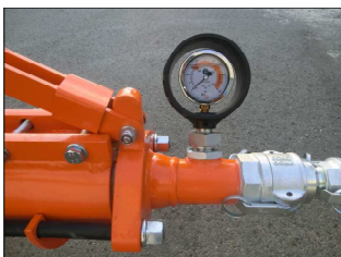
Рис. 17: Манометр давления раствора
