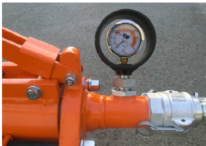
Рис. 22: Манометр давления раствора
