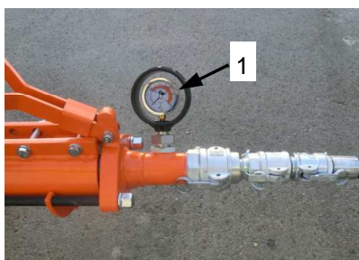
Рис. 65: Давление раствора на 0 бар
