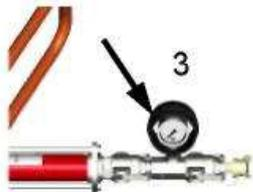
Рис. 32: Манометр давления раствора
