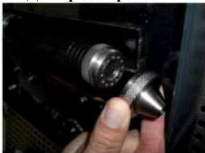
Рис.22: Отвинтить насадку.
