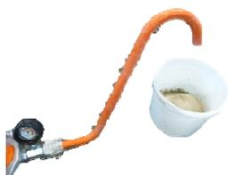
Рис. 65. Труба для контроля консистенции раствора
