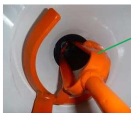
Рис. 109. Гнездо ротора
