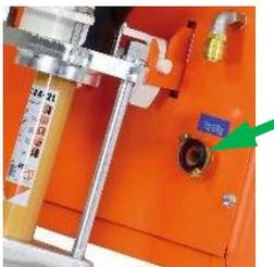
Рис. 120. Грязеулавливающая сетка на впуске воды
