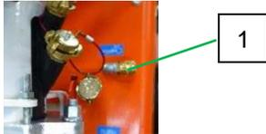
Рис. 71. Подключение воздушного шланга
