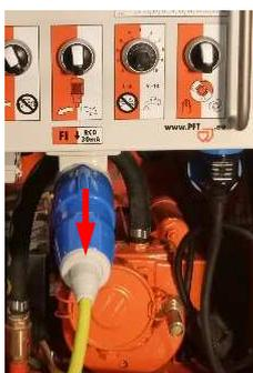
Рис. 119. Извлечение соединительного кабеля
