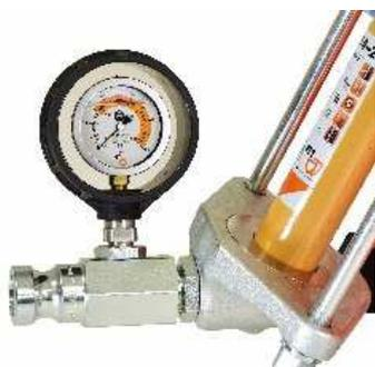
Рис. 41. Манометр давления раствора
