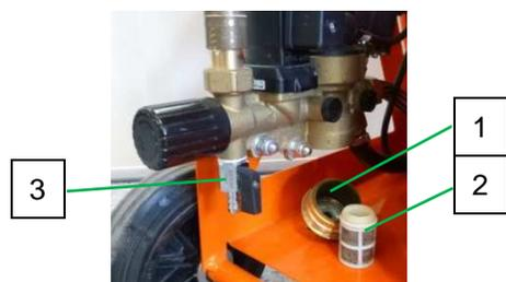
Рис. 51. Грязеулавливающая сетка
