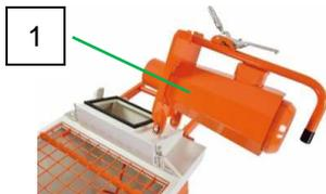
Рис. 42. Опускание упорного буртика
