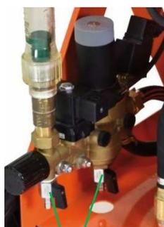
Рис. 116. Открытие водоспускного крана
