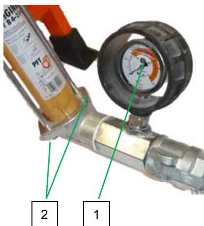
Рис. 72: Проверка давления раствора
