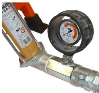
Рис. 51: Манометр давления раствора
