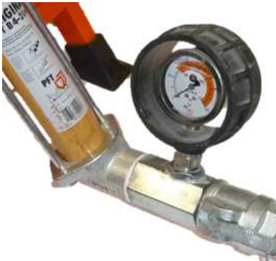
Рис. 26: Манометр давления раствора
