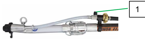
Рис. 62: Закрытие воздушного крана
